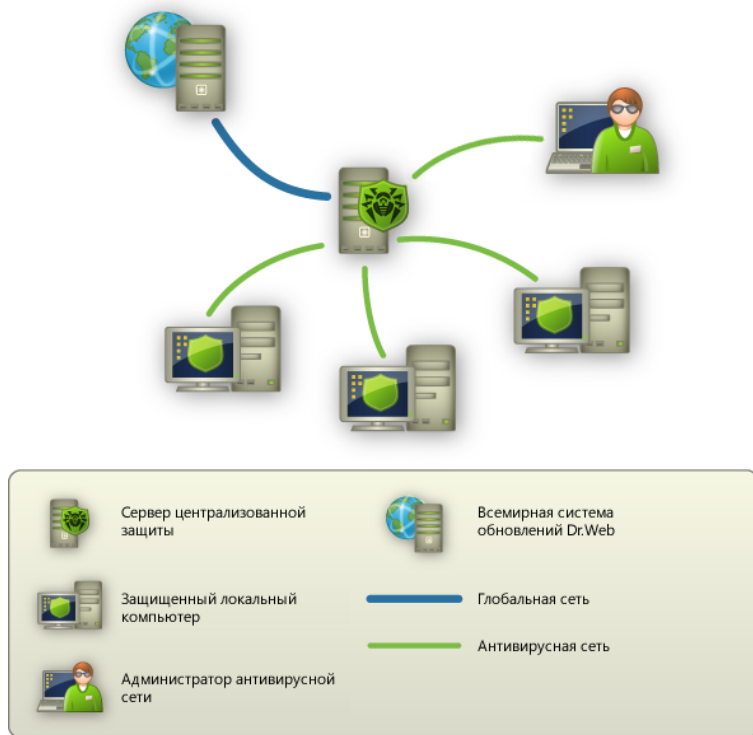
Рисунок 32. Логическая структура антивирусной сети.
